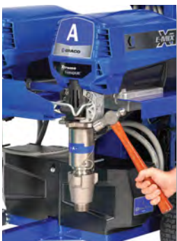
1. Loosen jam nut
